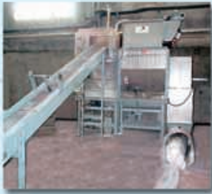
Pneumatic Conveying with Venturi Ejector Pneumatische Förderung mit Venturi-Ejector Transport pneumatique avec éjecteur Venturi Trasporto pneumatico con eiettore Venturi
