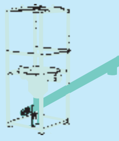
WITH TUBULAR SCREW FEEDER MIT DOSIERSCHNECKE AVEC VIS TUBULAIRE CON COCCLEA TUBOLARE
